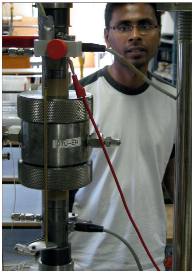
Måling af petrofysiske egenskaber. Monzurul Alam måler de petrofysiske egenskaber på kalkprøver fra Syd Arne. Ved at måle på prøver fra forskellige trin i injektionsprocessen vil han vise, hvad der sker med kalken, når man bruger CO 2 til at øge olieindvindingen med. Foto: Henrik Olsen.
